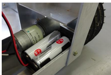
(写真-f) 受信機用電源ボックス
