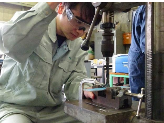
穴あけ加工(ボール盤)
